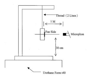
1 METER FROM MICROPHONE TO FAN INTAKE
